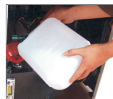
倒入液压油，关盖和柜门
